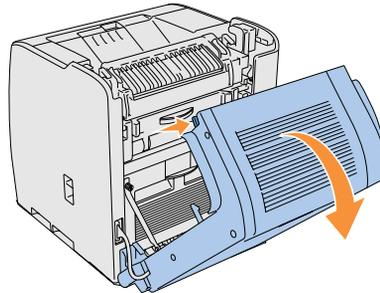
1. Pour ouvrir les deux capots de l'imprimante, saisissez l'encoche du panneau avant et tirez vers l'avant. Soulevez le capot supérieur et tirez vers l'arrière.
