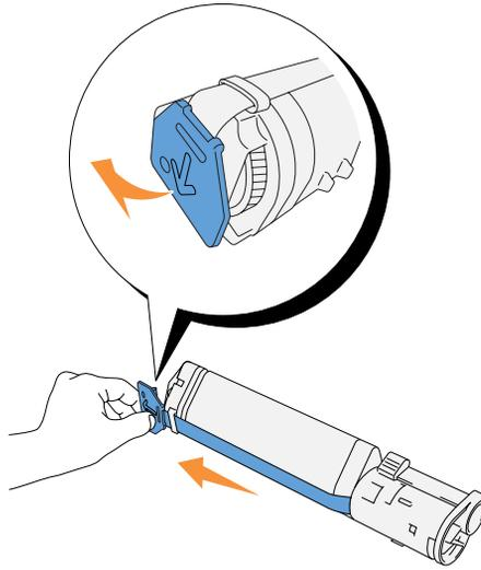
3. Pour insérer la cartouche de toner, alignez les flèches situées sur la cartouche sur les flèches correspondantes situées sur l'imprimante. Insérez la cartouche jusqu'à ce qu'un déclic confirme sa bonne mise en place et poussez ensuite la poignée vers le bas pour verrouiller la cartouche en place.
