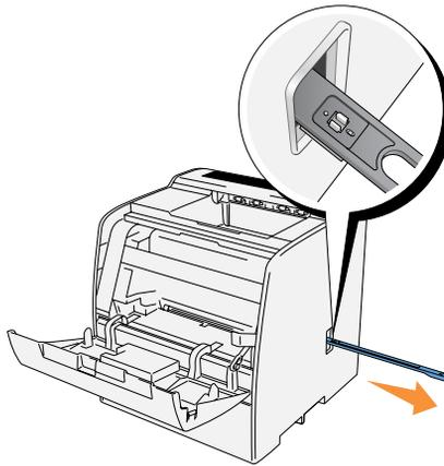
3. Appuyez sur les deux onglets du tampon nettoyeur afin de retirer le tampon.
