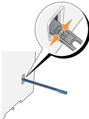
4. Maintenez le nouveau tampon nettoyeur sous la baguette de nettoyage et insérez-le jusqu'à ce qu'un déclic confirme sa mise en place.
