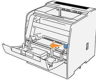
2. Tirez sur la baguette de nettoyage jusqu'à ce que le tampon nettoyeur soit éjecté de l'imprimante.
