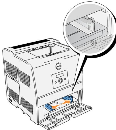
3. Insérez le support d'impression dans le chargeur, face d'impression recommandée vers le haut.
