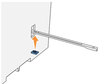
5. Remplacez la baguette de nettoyage dans sa position originale jusqu'à la butée.
