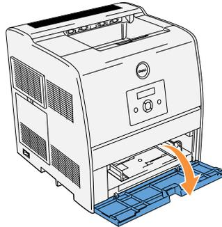
2. Faites glisser les guides de largeur vers le bord du tiroir. Les guides de largeur doivent être placés complètement contre le bord du tiroir.
